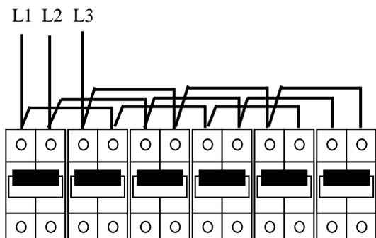
**Примечание:** перемычки изготавливаются из провода сечением и маркой аналогичной кабелю подключения!
